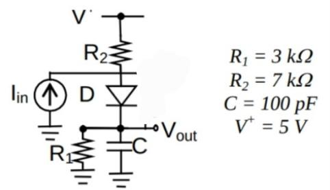
a. Tracciare il diagramma temporale, quotandone tutti i punti significativi, della tensione di uscita  $V_{out}$
