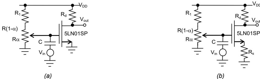
Data l’elevata variabilita’ dei parametri del transistor ci si propone innanzitutto di caratterizzare i parametri dell’esemplare di transistor utilizzato, andando a tracciarne le caratteristiche di uscita e la transcaratteristica. Si procedera’ quindi alla determinazione del punto di lavoro desiderato per il proprio amplificatore e all’analisi di piccolo segnale. Si concludera’ l’analisi delle prestazioni del circuito studiando sperimentalmente la funzione di trasferimento dello stadio.
