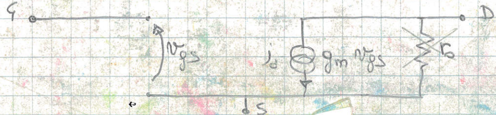
MODELLO PER PICCOLI SEGNALE PER N- E P- MOSFET.
