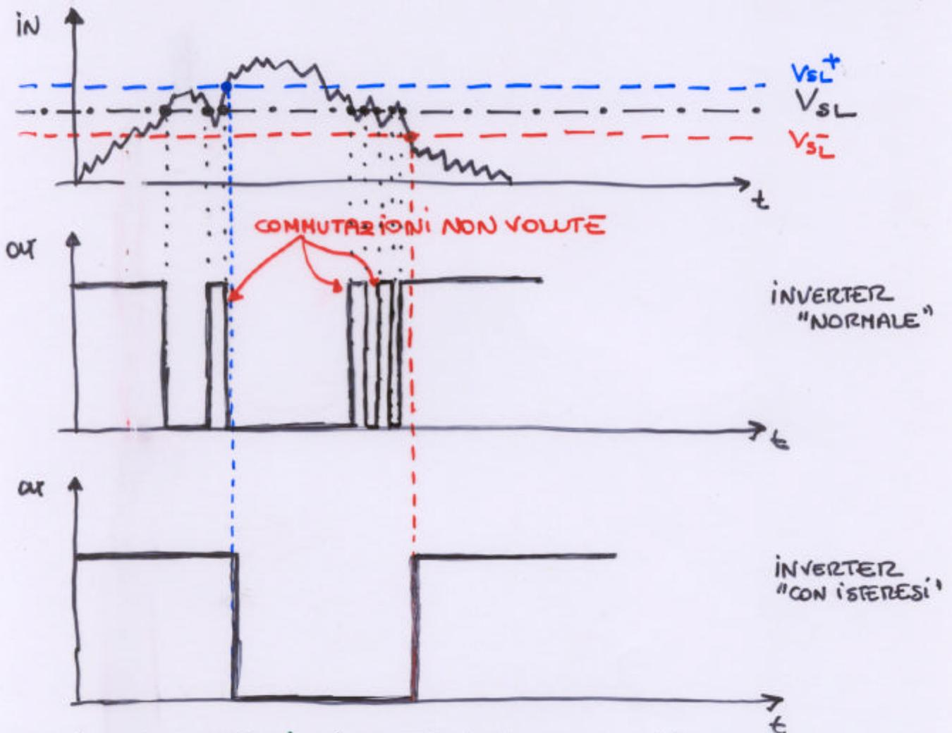
Lo previene commutazioni spurie in presenza di rumore sovrapposto al segnale: se  $V_{SL}^+ - V_{SL}^- >$  dell'ampiezza del rumore si ha una sola commutazione all'uscita dell'inverter "con isteresi"
