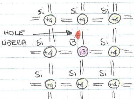
Se sostituiamo un atomo di Si con un atomo di B (III colonna), un elettrone che si trova nelle vicinanze può essere "accettato" per formare quattro legami covalenti con gli atomi di Si adiacenti.
