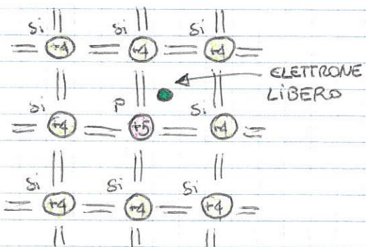
Se sostituissimo un atomo di Si con un atomo di P (V colonna), quattro dei cinque elettroni di valenza formano legami covalenti, mentre è sufficiente un'energia termica modesta perché il quinto elettrone sia disponibile per la conduzione. Gli elementi della V colonna sono, pertanto, IMPUREZZE DONATORI per il Si.
