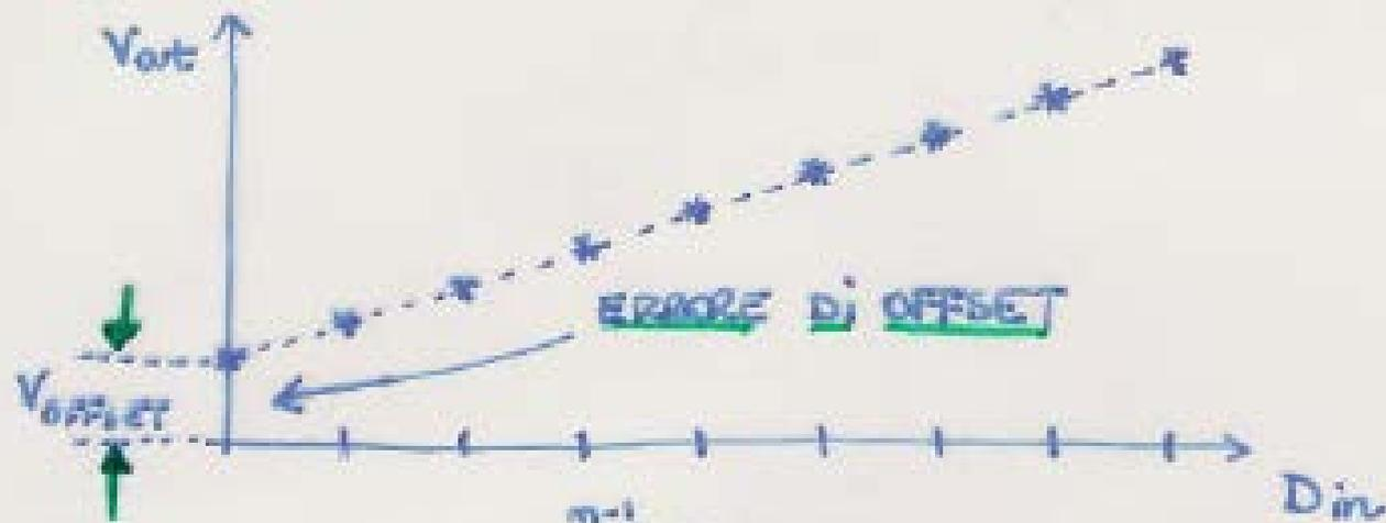
$$V_{OUT} = \frac{V_{REF}}{2} \sum_{i=0}^{n-1} \frac{D_{(n-1)-i}}{2^i} + V_{OFFSET}$$
