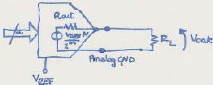
Esempio: DAC 3V 558 D:  $R_{out} = 4 \text{ k}\Omega$ ,  $V_{REF} = 5 \text{ V}$ , 8 bits
