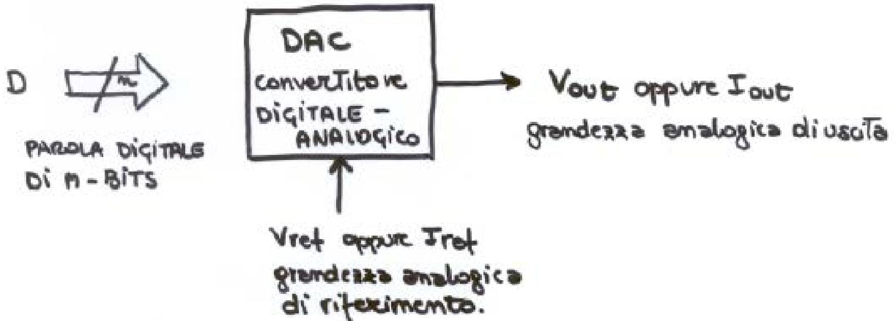
**TENSIONE DI FONDO SCALA ( $V_{FS}$ )**: massimo valore della Tensione analogica di uscita
