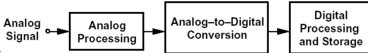
Pre-elab. analogica, conversione A/D, elaborazione digitale
