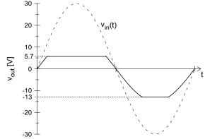
3. Quando l'ampiezza del segnale in ingresso e' pari a 20V la corrente massima attraverso il diodo si ha quando il diodo e' polarizzato in diretta.
