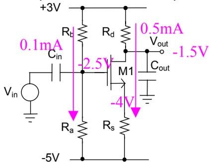
Il transistore opera in zona di saturazione e la transconduttanza vale:
