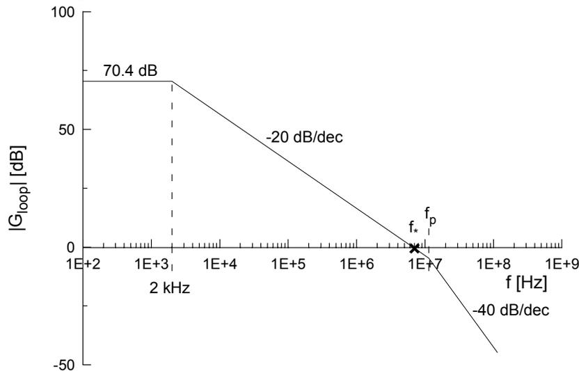
Per garantire un margine di fase di almeno  $60^\circ$  il secondo polo deve trovarsi dopo l'attraversamento dell'asse 0dB. La frequenza di attraversamento dell'asse 0dB risulta, pertanto, data da  $f_* = G_{loop}(0) * f_0 = 6.59MHz$ .
