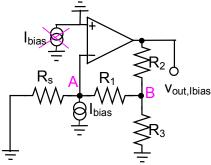
Il generatore di corrente di bias al morsetto non invertente non ha effetto perche' tutta la corrente e' direttamente drenata a massa.
