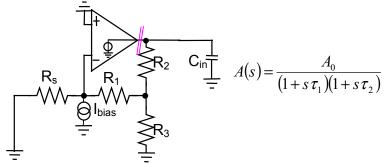
Per calcolare il margine di fase occorre calcolare il  $G_{loop}(s)$ . Il condensatore  $C_{in}$  non introduce alcun
