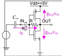
$$v_{out} - v_{in} = i_R R$$
