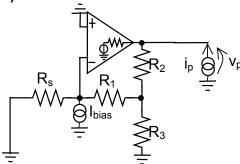
La retroazione tende ad abbassare la resistenza di uscita.
