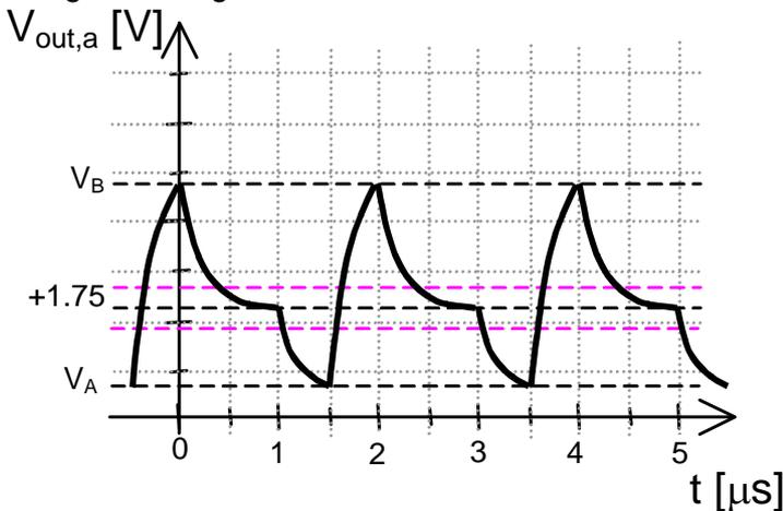
Occorre calcolare i livelli  $V_A$  e  $V_B$  per controllare se il trigger di Schmitt puo' ancora commutare. Sfruttiamo il fatto che il segnale di uscita  $V_{out,a}$  sicuramente raggiunge il livello di  $+1.75V$ .
