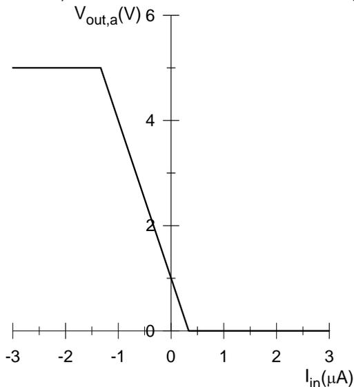
Calcoliamo l'espressione delle soglie di scatto del trigger di Schmitt mostrato in Fig. 1b. La soglia di scatto e' quel valore di  $I_{in}$  tale che  $V^+ = V^-$ .
