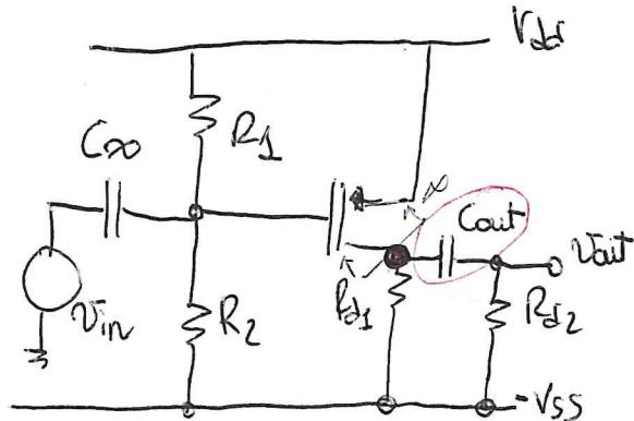
4. Dim.  $C_{out}$  per segnali con  $f \in [100\text{Hz}, 100\text{kHz}]$
